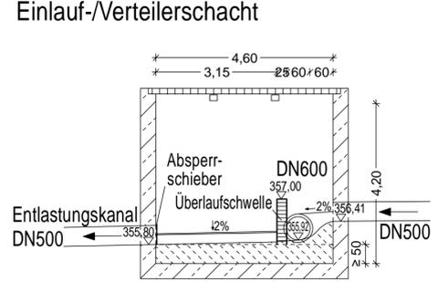
**Schnitt B-B Einlauf-/Verteilerschacht** M=1:100
