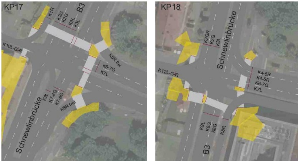
Abbildung 42: Signalgruppen Schnewlinbrücke Nord (K17) und Süd (K18)
